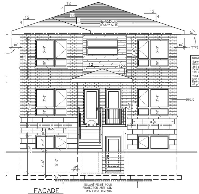
Élévation avant triplex
